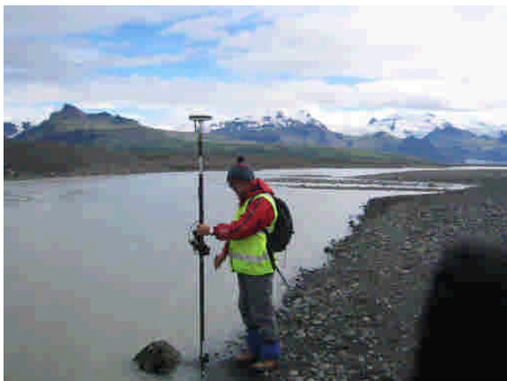
(写真16：GPSで測定中)
