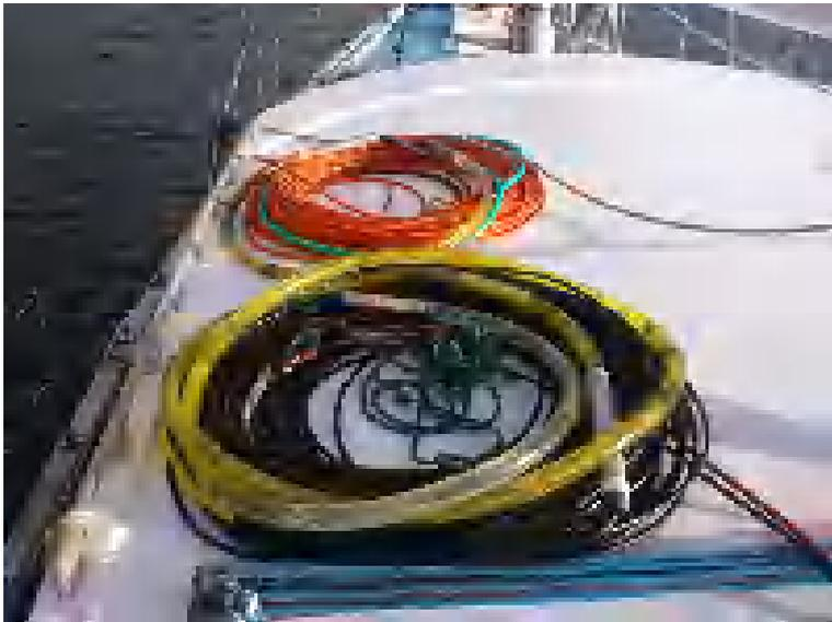
黄色いチューブの部分にマイクが入っています。黒いケーブルで水中20メートルほどの深さを曳航しながら水中の音を採集します。「クリック」「ホイッスル」「シュリンプ」を聞き分け、記録します。
