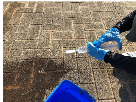
写真2 採水した海水(合計1L)をカートリッジ型のフィルターでろ過
