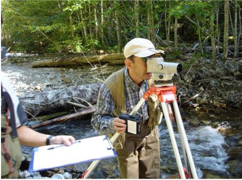
GPS を利用し基点を決め、川原の幅・水面の幅・川の深さ土地の高さなどを測量し、それをもとに正確な地図を作っていきます。
